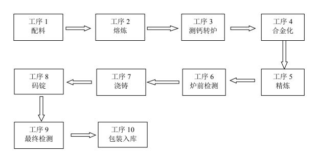
图 2 铝锭主要生产工艺流程示意图
